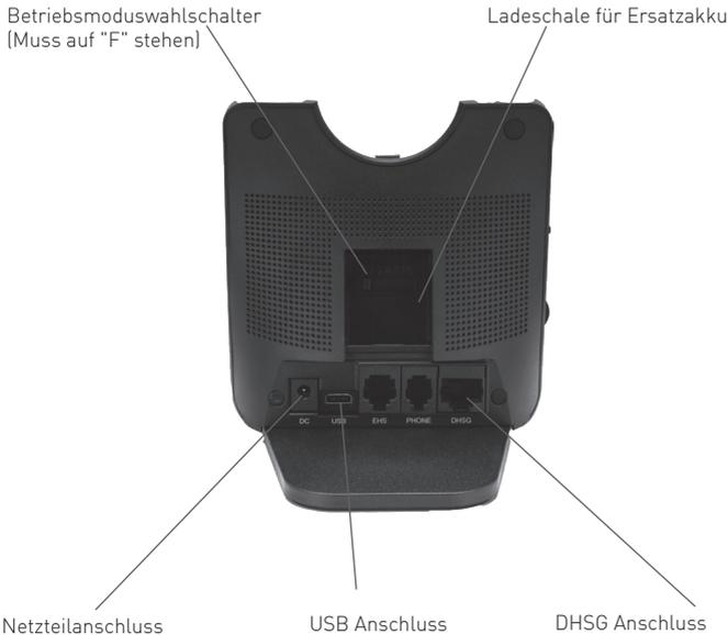
AGFEO empfiehlt zum Anschluss der Basis an Ihrem Systemtelefon ein Patchkabel (1:1) mit einer maximalen Länge von 100 cm, um eventuelle Störeinstrahlungen zu vermeiden. Bitte beachten Sie, dass das Kabel auf einer Seite über einen kurzen Stecker verfügen sollte. Ein passendes Kabel kann über den AGFEO Service mit der Bestellnummer 1104501 bezogen werden.
